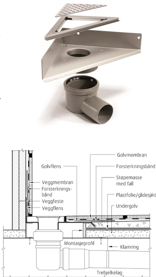
Figur 4: System Unidrain Hjørne med golvavløp, avløpsenhet, ramme og rist.
